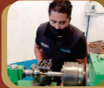
4.1.- Maquinados en la extracción y fabricación de probetas.
